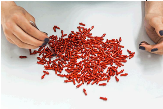
Die Qualitätskontrolle kann entweder manuell oder mithilfe automatisierter Systeme zur lagerichtigen Zuführung und kameragestützter Bildanalyse erfolgen (Foto: MaxSolution)
