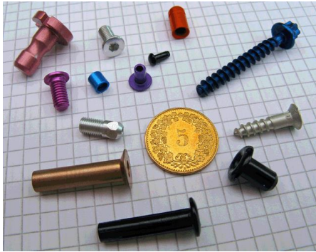
Eine Auswahl von Bauteilen, die sich gut für das Trommelanodisieren eignen (Foto: Klaus Vollrath)
